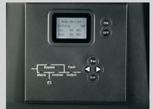
Bedienfeld: Bis zu 50 Parameter über LCD einstellbar
